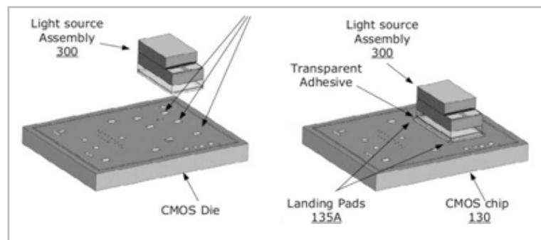
Figure 4: Luxtera EEL TxRx Module
